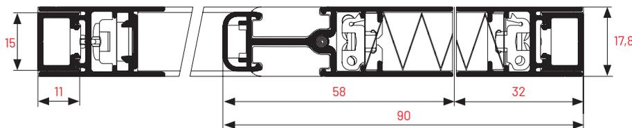
Das Gewebe wird durch Profile bis zu einer Länge von 900mm geschützt
