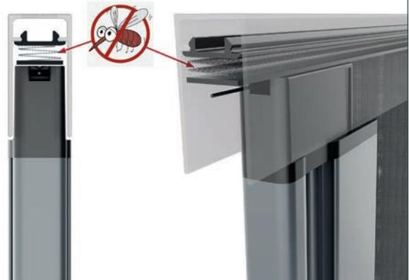
**Optional** gegen Aufpreis erhältlich ist die obere Führungsschiene mit Netz, um jeglichen Durchschlupf von Insekten zu verhindern.
