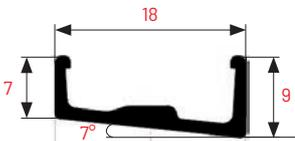
Aluminium schräge Bodenschiene
