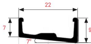
Aluminium schräge Bodenschiene
